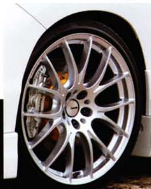
ジャパンクオリティを誇る鍛造1ピース、レイス・ホムラ2×7、メッシュから覗くのは6ポット&355φローターのハイパフォーマンスブレーキシステム。
