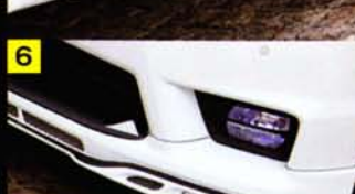
4リアのテールライト下にあるコーナーパノールと交換することで、2連ダクトを簡単にインストールできるアイテム。5プレミアムエディション専用となる左右4本出しマフラー“プレミアム01S”。120×80φオーバーバルブ採用でスポーティなリアビューを演出。ちなみにバージョン1のヴェステイタリアアハブには装着不可となっている。新規制基準対応。6フロント両サイドにインストールされる4個のLEDスポット。無しのタイプも選べる。
