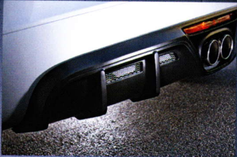
90φ×2のセンター出しマフラーと、マットブラックで塗装された専用ディフューザー。アルミ素地のダクトメッシュは標準装備となる。
