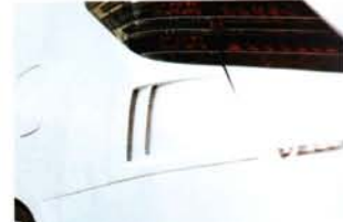
※気軽にダクトが追加できるリアコーナーパネル。空気抵抗を確実に底上げできる技ありなアイテム。装着時にボディとすんなり一体化、自然な躍動感を醸し出す。
