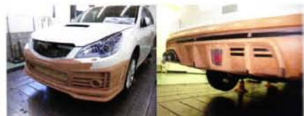
トミーカイラ・ジャパンでは、自社にクレイモデルルームがあり、実車をベースに専任のモデラーが製作エアロを製作している。ここまでこだわって、さらに、微妙なデザインワークが可能になるのだ
