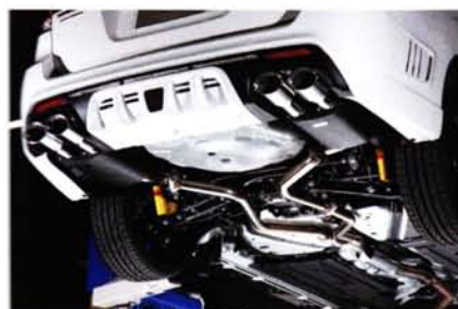
エキゾーストシステム「プレミアム01S」は、ストレートパイプとセンターパイプも用意。リアピースは、バンパーに合わせて長さ調整できるタイプもある
